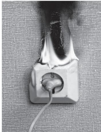
Как известно, соединение меди с алюминием создает гальваническую пару, в которой под воздействием влаги и электрического тока происходит процесс электролиза, и, как следствие, разрушение контакта. Со временем контакт будет греться и может возникнуть возгорание проводки. Такое может произойти, если медный и алюминиевый провод соединить напрямую простой скруткой. К сожалению, на практике мы не раз встречались с подобными соединениями.
